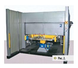
стол позволяет совместить загрузку/выгрузку изделий в одной позиции, с их сваркой – в другой. На каждой позиции свариваются одновременно по два изделия «поводок» (рис. 3) с их поворотом в два положения относительно горизонтальной оси. Комплекс оснащен быстросменными приспособлениями для переналадки под сварку различных типов изделий. Время сварки одного «поводка» — около 60-и секунд.
