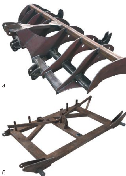
Рис. 1. Примеры металлоконструкций сельхозтехники: а) «Рыхлитель», сварено на комплексе РК759-1, б) «Рама», сварено на комплексе РК759-2
