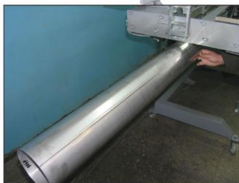
Рис. 2. Внешний вид сварного шва
