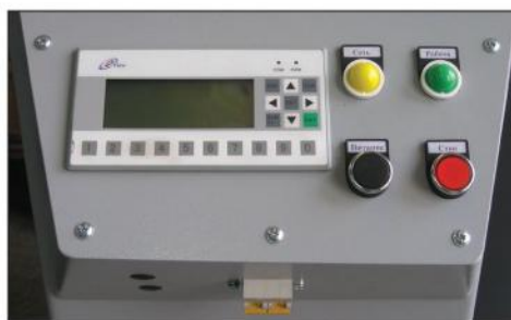
Рис. 3. Панель оператора установки АС333
