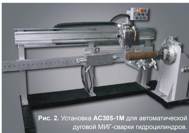
Рис. 2. Установка АС305-1М для автоматической дуговой МИГ-сварки гидроцилиндров.
