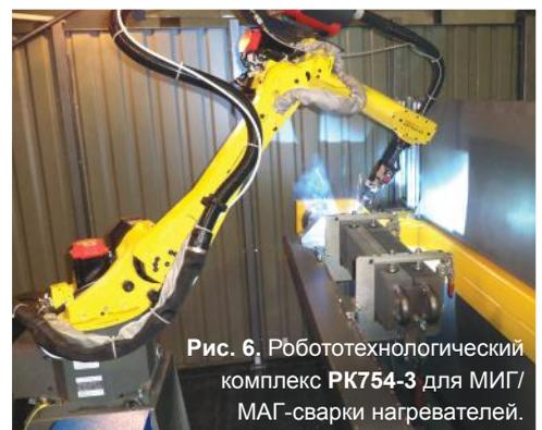
Рис. 6. Робототехнологический комплекс РК754-3 для МИГ/МАГ-сварки нагревателей.
