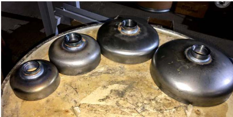
Рис. 2. Донишко и горловина огнетушителя после сварки
