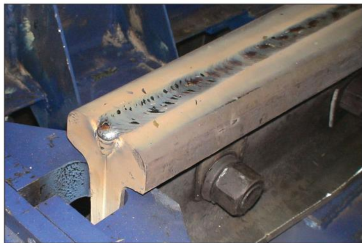
Рис. 2. Внешний вид сварного шва со стороны головки рельса
